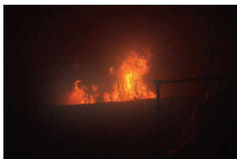
30 minut od rozpoczęcia testu – powierzchnia badana płonie
